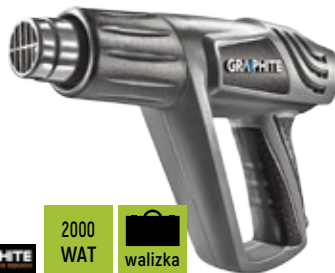
Opalarka 2000 W przeznaczona do usuwania powłok lakierniczych, wyginania i zgrzewania termoplastów, odmrażania, suszenia oraz okleinowania elementów meblowych
