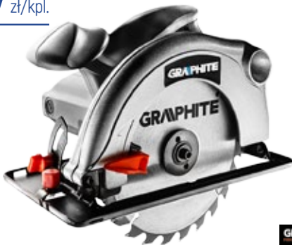
Pilarka tarczowa 1200 W do 5000 obrotów tarczy na minutę, cięcia pod skosem w zakresie od 0° do 45°, maksymalna grubość ciętego materiału do 65 mm
