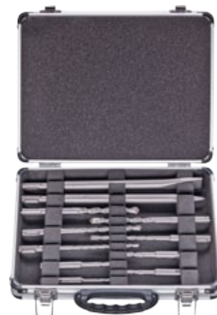
Zestaw wiertel i dłut SDS-PLUS w walizce przeznaczenie: do betonu, do kamienia; 11 sztuk, średnica: 5, 6, 7, 8, 10, 12 mm, dł. robocza: 50/100 mm, dł. całkowita: 110/160 mm, szpicak 250 mm, dłuto 250 mm
